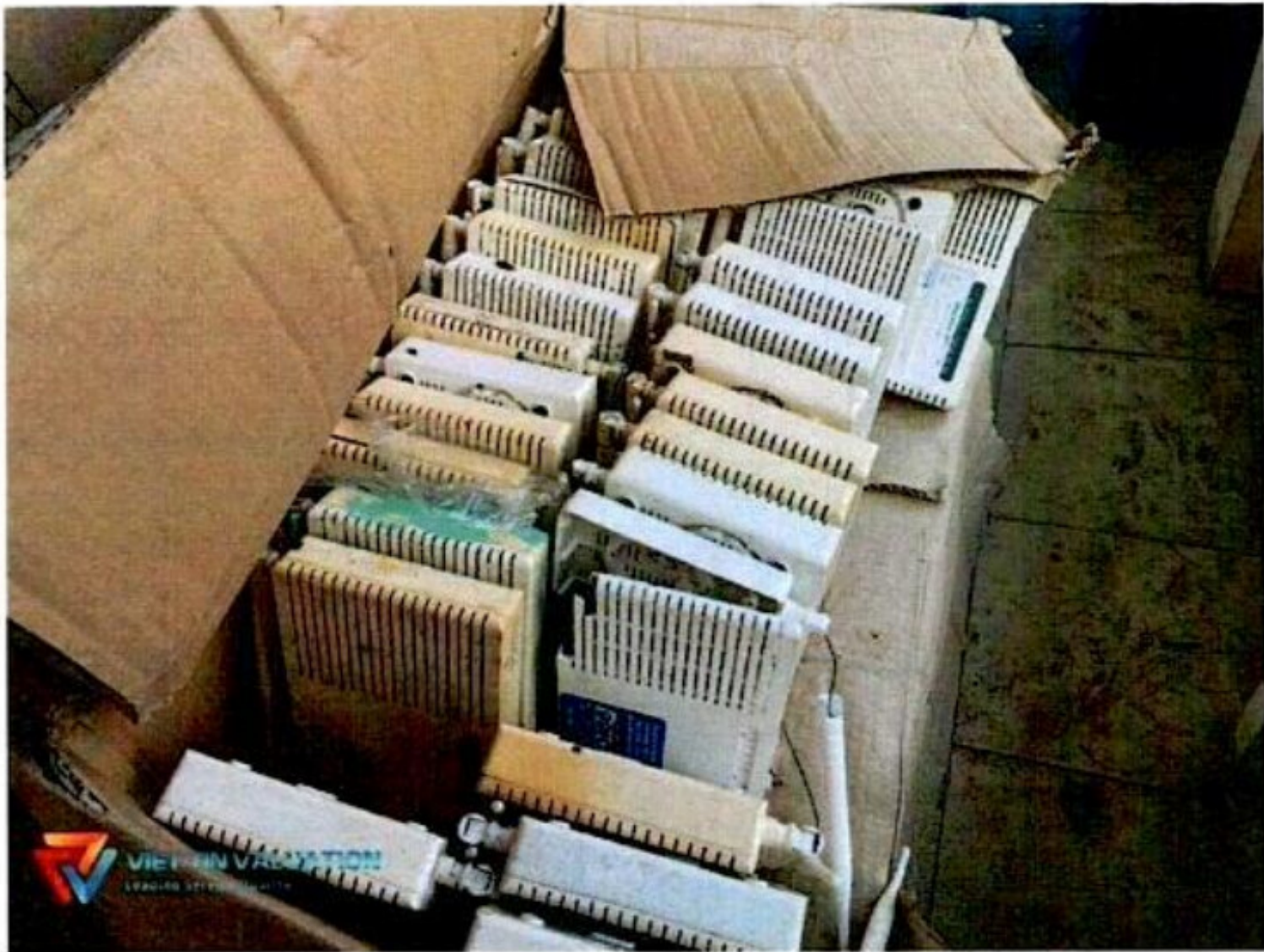
Hình 17: Các loại thiết bị đầu cuối (Modem, Gpon các loại) đã qua sử dụng
