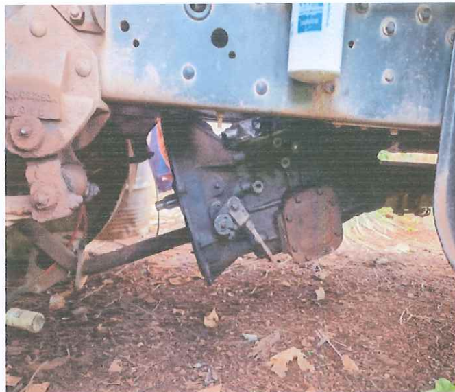
Hình 6: Trục động cơ bị gãy
