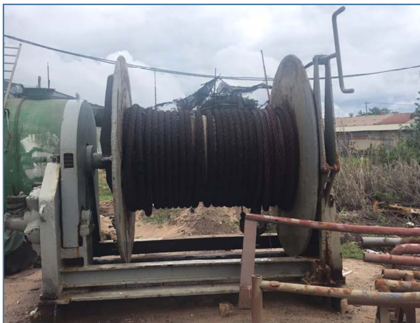
Tời quấn giấy: Kích thước tời : D \times R \times C = 1600 \times 3000 \times 2300 mm Trọng lượng tời và cáp: ~ 11 tấn, cáp D40mm, dài 50m.
