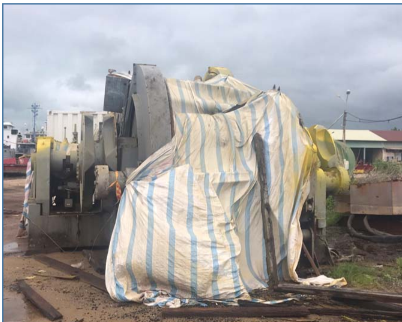
Tời kéo chính: Kích thước tời : D \times R \times C = 5751 \times 4500 \times 3270 mm Trọng lượng tời và cáp: ~ 80 tấn, cáp D58mm, dài 2000m.
