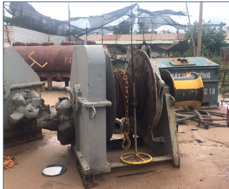
Tời tigger mạn trái: Kích thước tời : D \times R \times C = 1300 \times 1300 \times 1650 mm Trọng lượng tời và cáp: ~ 8 tấn, cáp D22mm, dài 200m
